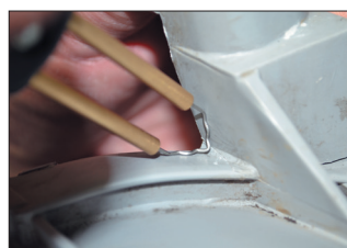
Скобы угловые 0.8 мм для ремонта внутренних и внешних углов крепёжных элементов.
